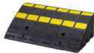
PARK-DH-UP-3M Ράμπα χρωματιστή 20cm Γεφυρώνει το επίπεδο του δρόμου με πεζοδρόμιο 20cm 600 × 450 × υψ200mm (30 kg)
